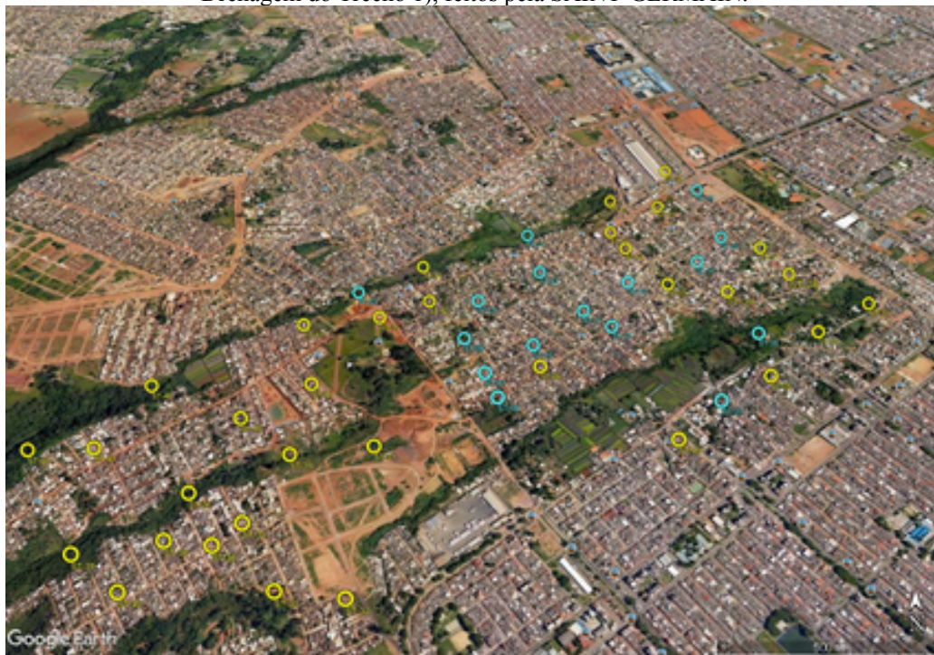
Figura 1.1.6 - Localização atual dos 16 pontos de Sondagem a Trado com presença de água (Rede de Drenagem do Trecho 1), feitos pela SAINT-GERMAIN.
